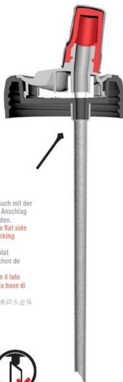
Stülpen Sie den Schlauch mit der flachen Seite bis zum Anschlag auf den Verschlussboden.
